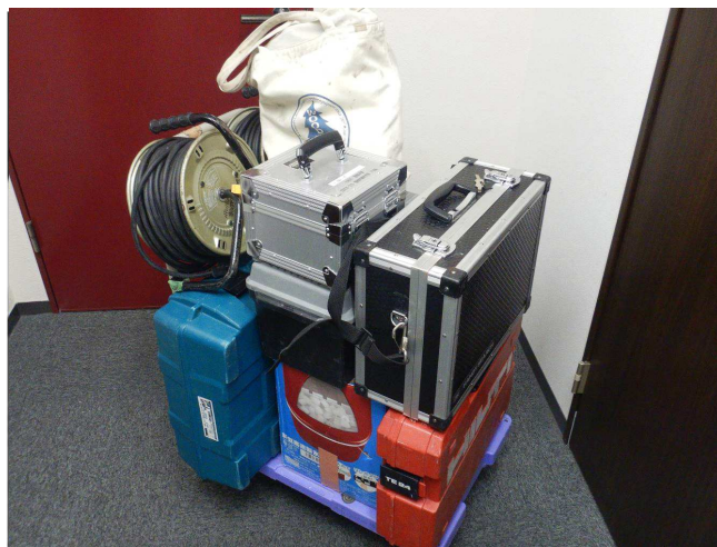
台車に載せられ、搬出を待つ調査機器箱に入った状態を目にするのは、かえって珍しいのでは？ 左上：コードリール、中央上：引張試験機、右上：鉄筋探査機、 右下：ハンマーコアドリル、中央：工具箱(工具類を入れている)、 中央下：集塵機、左下：ダイヤモンドコアドリル、 一番上の袋の中身は調査者が着用する腕章など
