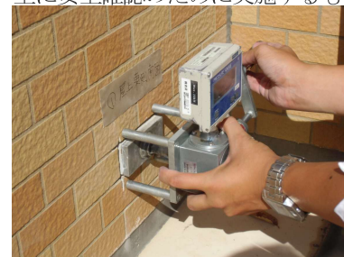
タイルの付着強度試験のようす
