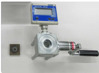
油圧式引張試験機とアタッチメント (左)
