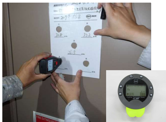
測定風景(右下:デュアルタイプ膜厚計)
