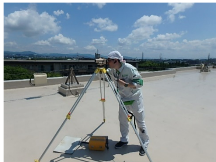
オートレベルを用いたレベル測定の様子 測定地点に設置した箱尺の目盛りを オートレベルを覗いて読み取る筆者
