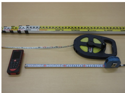
奥から、箱尺、巻尺、一般的なメジャー 手前左はレーザー測距計
