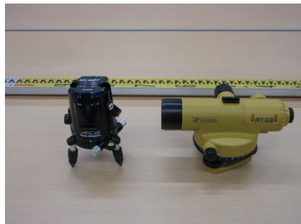
奥は箱尺。手前右はオートレベル 同左はレーザーレベル
